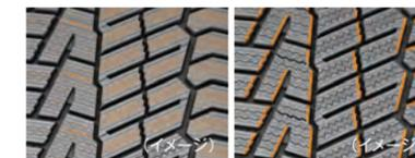
左右非対称にデザインされた「ゲッコウ・グラブ・パターン」を採用。表面に多方向の溝と無数のサイブ、そして立体的なエッジを刻むことで、ゲッコウ（ヤモリ）の足がガラスの上を容易に這うかのごとく氷を強力に掴み、コーナリングおよび発進、ブレーキング時に優れたグリップ性能を実現、氷上や雪上で安定したドライビングを提供します。
