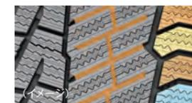
氷雪路以外でも快適な走行を提供するために、トレッド部に「千鳥トレッドパターン」を採用。この千鳥のような形状は、小さく分割されたブロックがパターンによる打撃音を減少、ジグザグの溝はノイズ周波数を分散させる効果があり、耳障りなノイズピークを抑制し高い静粛性を実現しています。
